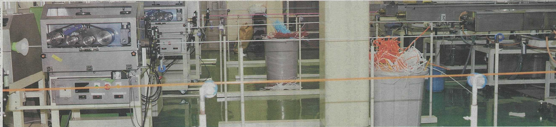
機械を通して引き伸ばされていくストロー。細い口金を渡したように見えるが、高速で動いている
