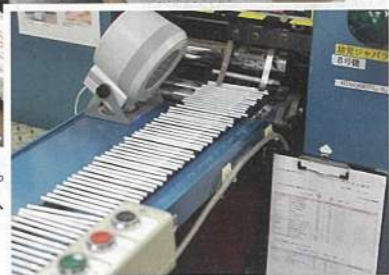
ストローのジャバラ(フレックス)を作る加工機。若手社員は機械の調整や修理作業を通じて、その仕組みを学んでいく
