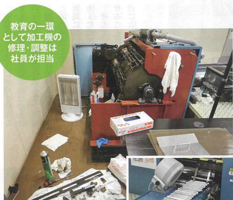
ストローのジャバラ(フレックス)を作る加工機。若手社員は機械の調整や修理作業を通じて、その仕組みを学んでいく
