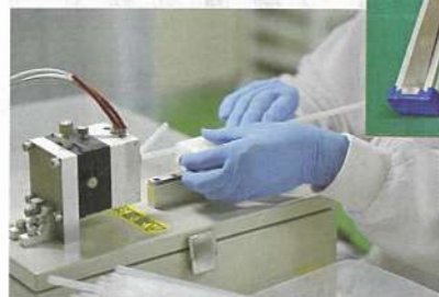
開発グループの妹尾亮汰係長が開発したストロー加工の自動化装置の試作機(中)。現在は手作業の工程(左)の自動化を試みたが実用化には至っていない
